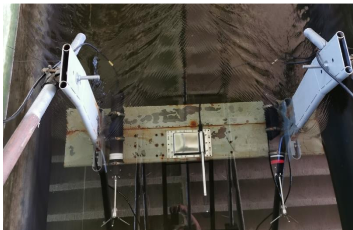
Slika 4. Parcijalni model rama pri ispitivanju sa UZV ADV i 3D EM sondama
